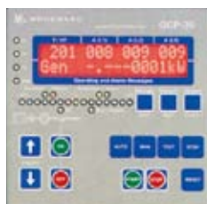
発電機コントローラGCP
